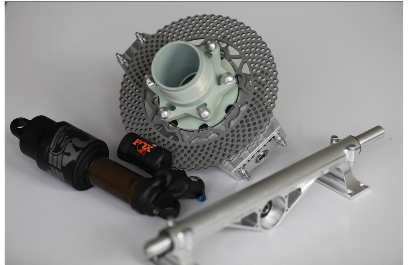
Bild 1: Stoßdämpfer, Radträger und Lenkgetriebe
