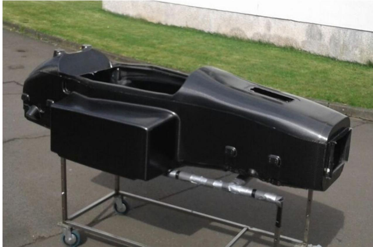
Bild 1: Monocoque ohne Nachbearbeitung
